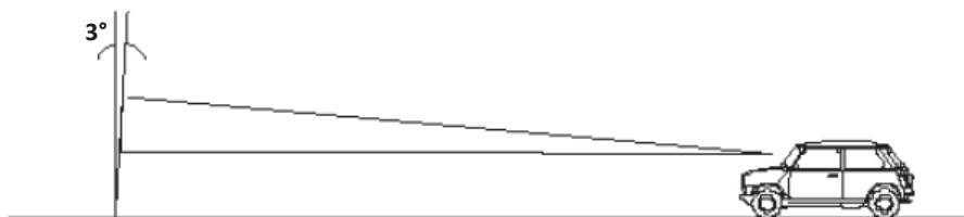
Figura 4 - Deflexão da placa em perfil.
