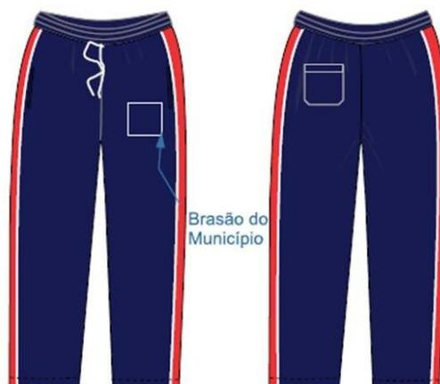
Confeccionada em malha, sendo sua estrutura helanca piquê, composição 62,3% poliéster e 37,7% algodão, fio oval, sendo o fio 1 = ne:20,84 / tex: 28,38 / cv %: 5,09 e o fio 2 = tex: 18,20 / dtex: 182,00 / denier: 163,80 / cv %: 0,59 com gramatura de 290g/m<sup>2</sup> (±2%), com espessura de 0,74mm,
